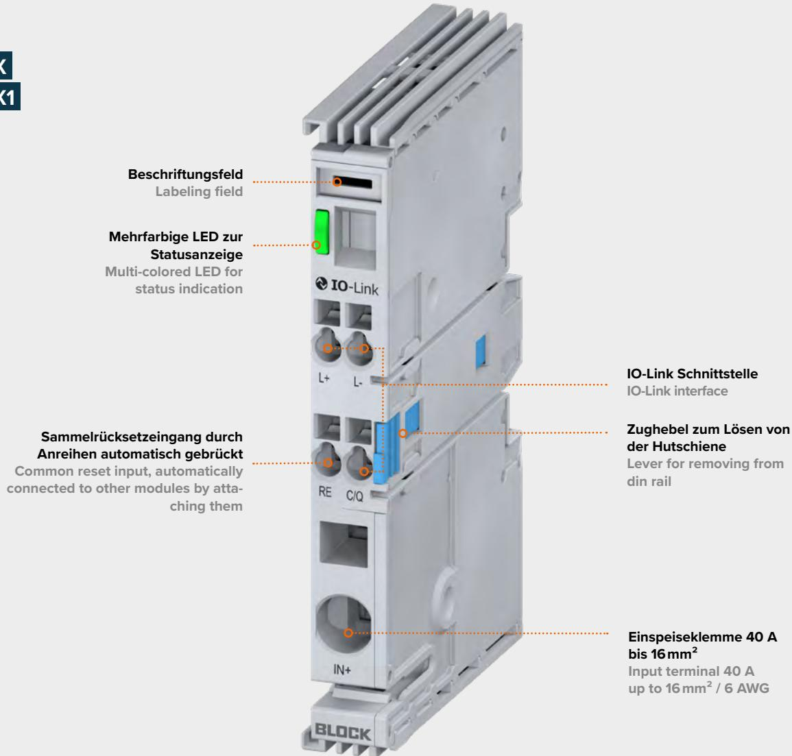
Die Kommunikationsmodule dienen als Schnittstelle zur Anbindung an eine übergeordnete Steuerung. Es kann mit Schutzschaltern der Ausstattungsvarianten EB-08, EB-18 und EB-38 sowie EB-07, EB-17 und EB-37 verbunden werden. Informationssammlung und -weitergabe der individuellen Betriebs- und Fehlerzustände sowie Parametrierung und Fernschalten von bis zu 40 Schutzschalterkanälen ist hiermit möglich.
