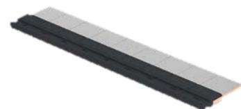
zu allen angereichten Modulen. Die Stromtragfähigkeit beträgt 80A. Als Standard wird der Querverbinder mit einer Länge von 492mm für 41 anzureihende Module angeboten. Optional stehen gekürzte Querverbinder zur Verfügung.
