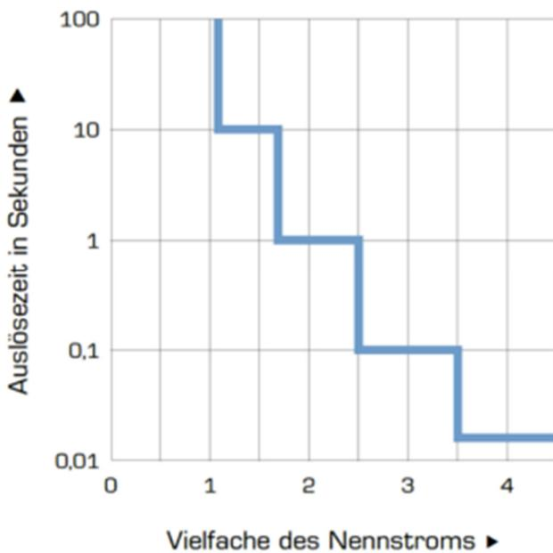
Die Auslösezeit ist von der Höhe des Überstromes abhängig. Bei einem Kurzschluss wird der fehlerhafte Stromkreis innerhalb von wenigen Millisekunden zuverlässig abgeschaltet. Die Höhe des Kurzschlussstromes ist von der Strombegrenzung des speisenden Netzteils sowie vom Leitungswiderstand abhängig.
