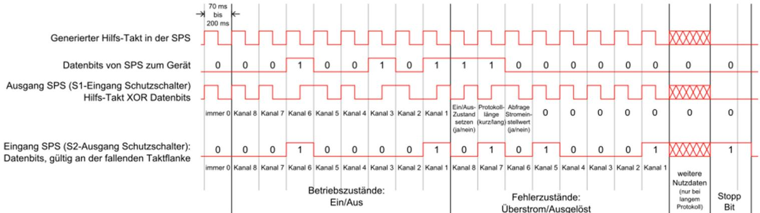
Es beginnt mit dem 3. Byte des Protokolls (weitere Nutzdaten) und beinhaltet insgesamt 9 Bytes. Diese sind mit dem höchstwertigsten Bit zuerst kodiert („MSB first“) und haben folgende Bedeutung:
