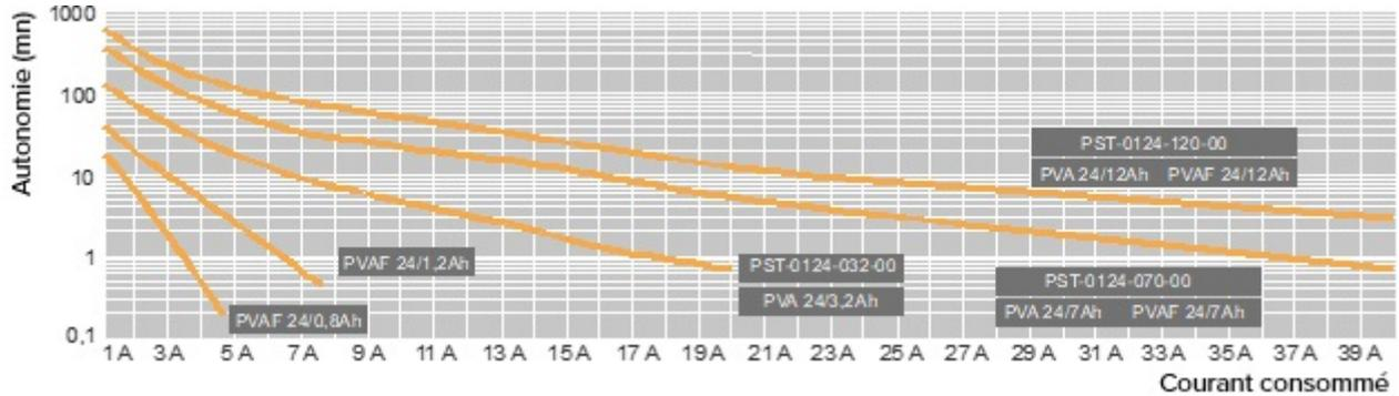
Figure 9: Temps d'autonomie du module de batterie
