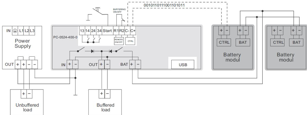
Figure 2 : Schéma du bloc de câblage
