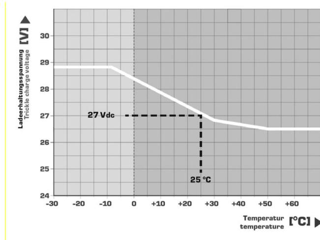
Figure 7: Courbe caractéristique de charge de compensation
