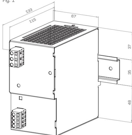
Die Stromversorgung wird mit dem an der Rückseite eingesetzten Schieber auf dem oberen Schenkel der Tragschiene TH35 angegesetzt. Die Aufrastung erfolgt durch Drücken der Stromversorgung in Richtung Tragschiene.
