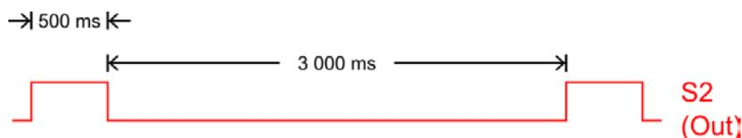
Ein digitaler Eingang der Steuerung muss daher den Signalkontakt S2 abfragen, um über Statusänderungen im Schutzschalter informiert zu werden. Gleichzeitig ist es in der Steuerung programmtechnisch zu vermeiden, ein Telegramm über S1 zu starten, während ein Impuls auf S2 durch den Schutzschalter erzeugt wird. Es wird empfohlen, vor Sendestart des Telegramms den jeweiligen Zustand auf S2 auszuwerten oder mindestens alle 3 Sekunden ein Telegramm zur Statusabfrage zu generieren.
